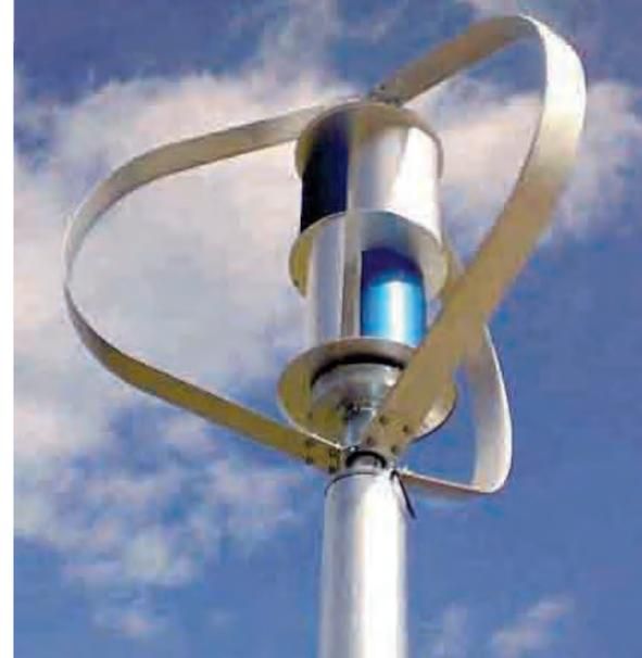
Figura 2 turbina mixta darrieus-savonius
