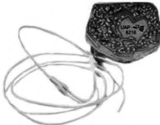
Figura 2. Marcapasos cardíaco de frecuencia fija diseñado y fabricado en el Departamento de Semiconductores de la Universidad Autónoma de Puebla en 1982, bajo la dirección del Dr. Alejandro Pedroza Meléndez, este marcapasos se implantó en perros. Los componentes electrónicos empleados en este marcapasos fueron también fabricados en dicho Departamento [4].
